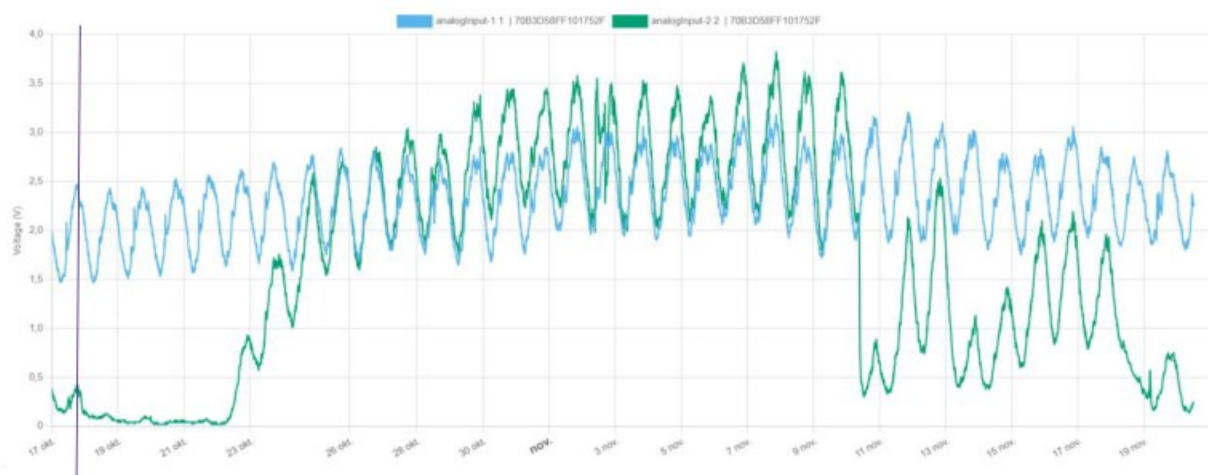
Figuur 26. Voorbeeld op varkensbedrijf, waarbij probleem met luchtwasser werd geconstateerd. De blauwe lijn geeft de gemeten waarden voor de luchtwasser weer en de groene lijn de waarden na de luchtwasser.
