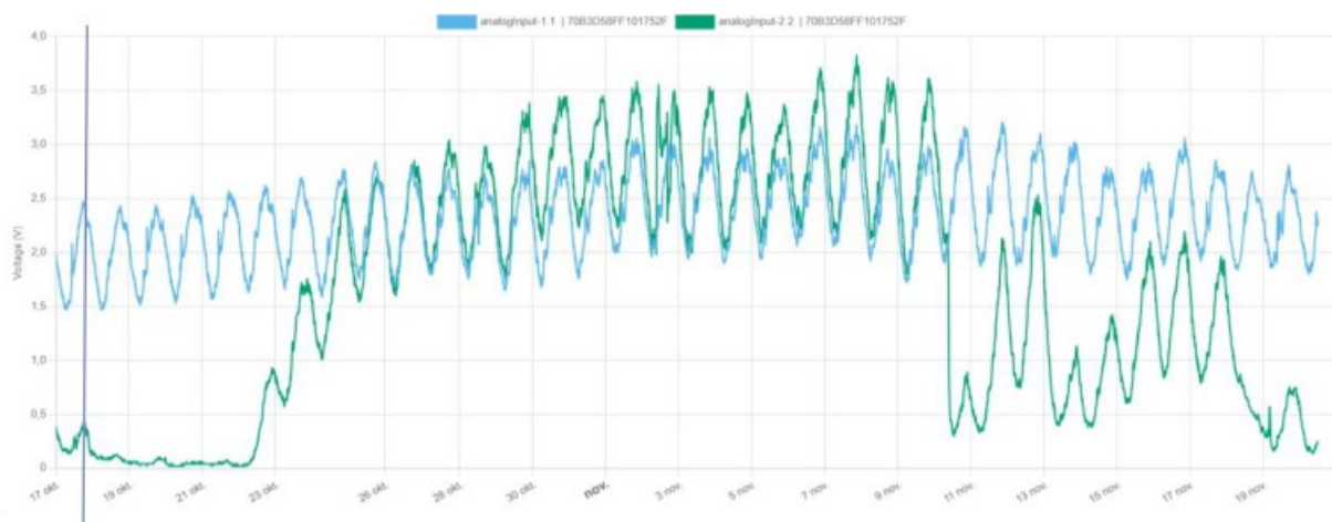
Figuur 23. Voorbeeld van een afwijking op varkensbedrijf. Op 17 oktober wordt eerste afwijking geconstateerd en vindt een onderhoudsbeurt plaats. Op 23 oktober wordt een defect geconstateerd. Op 1 november wordt door de monteur een reparatie uitgevoerd. Waarna op basis van de meetwaarden wordt geconstateerd dat het probleem nog niet verholpen is. Hierop zijn diverse acties uitgevoerd en is blijvend gemonitord. Vanaf 19 november wordt zichtbaar dat de wasser weer in balans komt.
