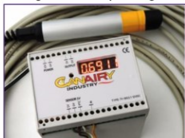
Figuur 6. Foto van een Canairy-sensor. Deze sensoren zijn ingezet in het project om geurstoffenpatronen te meten.
